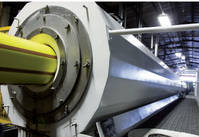
PE rúrka pri výstupe extrudéra
